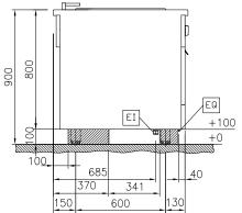
ΕI Electrical inlet (power) Equipotential screw EQ
